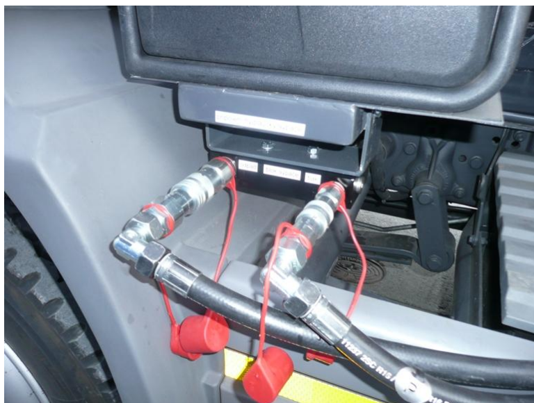
Pripojenie hydrauliky sypača za kabínou vozidla
